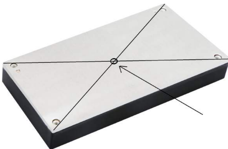
图10: 铝基板温度测试点
